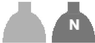
Esempio di vecchia e nuova colorazione distintiva per bombole contenenti Co2
