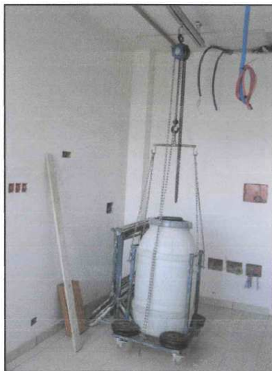
PROVE DI CARICO DURANTE INSTALLAZIONE
